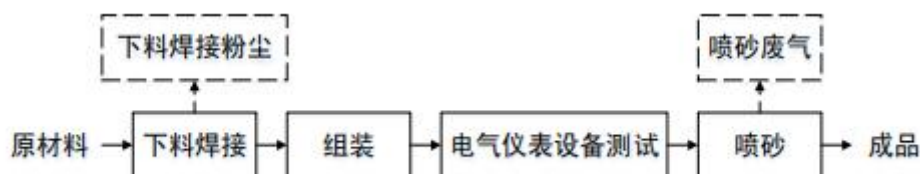
图 2-5 渗透汽化膜装置工艺及产污流程图
